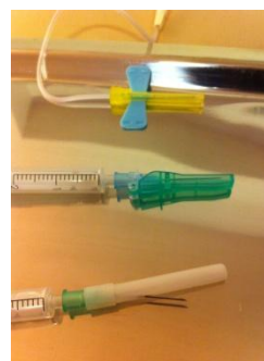
Foto 2: Geschlossene Sicherheitskanüle, unten durchstoßene Schutzkappe bei verbotennem Recapping.
